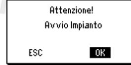
10. Selezionare l'opzione desiderata e premere la manopola per OK. Ora si avvierà l'applicazione, tutti i sensori impiegati saranno verificati, in caso di anomalie apparirà in seguito un messaggio di allarme lampeggiante. Apparirà il menù principale:
