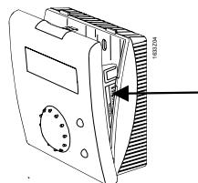
Socle démonté, appuyer sur la patte de verrouillage en haut à l'aide d'un tournevis et ouvrir l'appareil.
