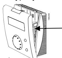
Vid demonterad bottenplatta kan den övre låsanordningen tryckas ner med hjälp av en skruvmejsel samt kapslingen öppnas.
