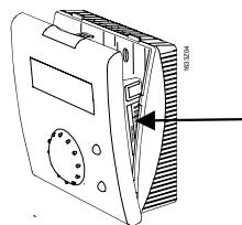
Bei demontiertem Sockel die obere Verriegelung mit einem Schraubendreher niederdücken und das Gehäuse öffnen.
