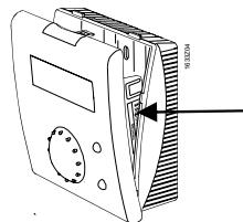
Basetta con incastro, premere con un cacciavite l'apposita leva nella parte superiore e rimuovere la custodia..
