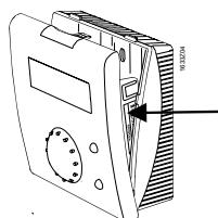
Skinuti uređaj i otvoriti kućište odvijačem
