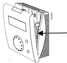
Pri demontáži sokla vrchné zablokovanie zatlačiť skrutkovačom dole a otvoriť prístroj.
