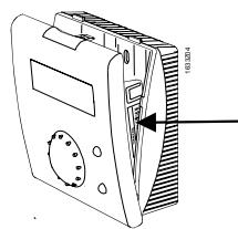
Po odstranění soklu stiskněte horní uzávěr s otočným šroubem a otevřete pouzdro.
