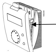
Con la base retirada, empujar la lengüeta superior con un destornillador, y abrir la carcasa.
