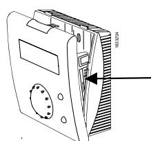
Odstranite podnožje in odprite ohiše tako, da zatik zgoraj z izvijačem pritisnete navzdol.
