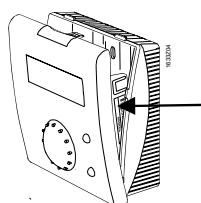
Skinuti osnovu i otvoriti kućište pritiskajući odvijačem vrh odozgo na dole.
